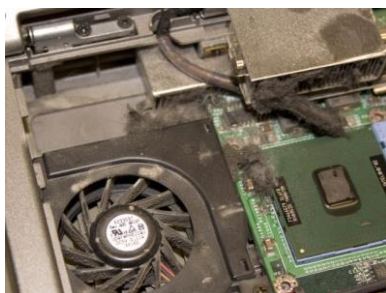
Slika 2. Primjer procesora s onečišćenim ventilatorom ( https://4bds6hergc-flywheel.netdna-ssl.com/wp-content/uploads/2015/06/dirty_laptop.jpg , 2.5.2018.)
