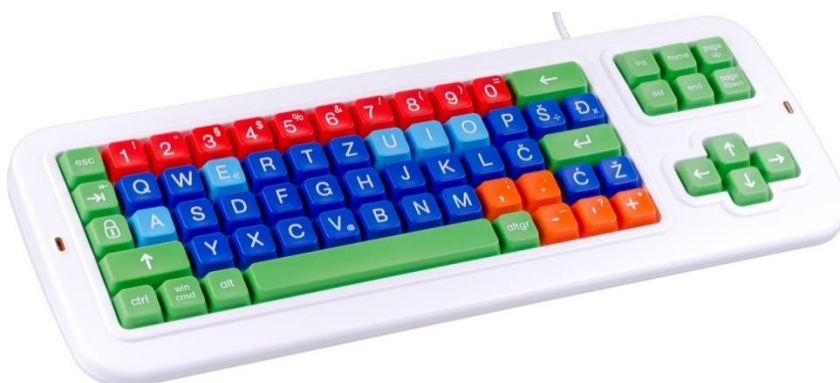
Slika 9 Asistivna tipkovnica s uvećanim tipkama za hrvatski jezik, http://www.bnc-distribution.com/
