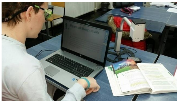
Slika 18 Korištenje elektroničkog povećala za povećanje teksta iz udžbenika
