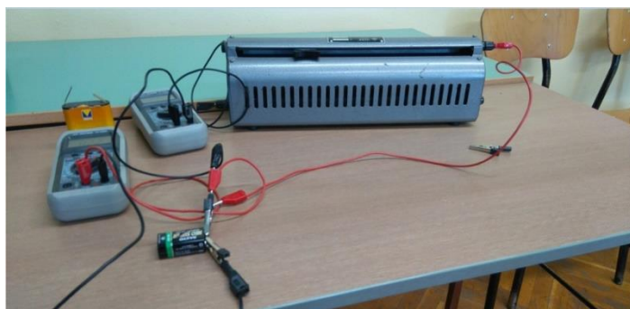
Slika S5.2. Određivanje unutarnjeg otpora baterije
