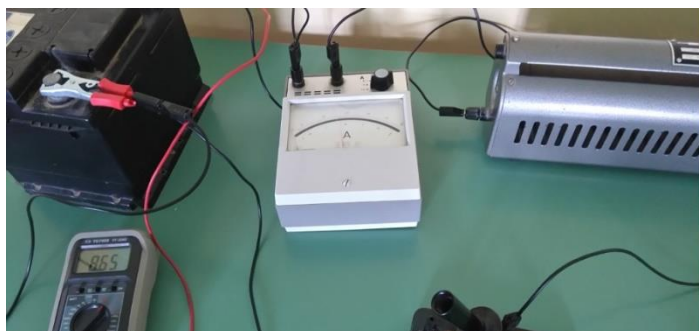
Slika S5.1. Određivanje unutarnjeg otpora akumulatora
