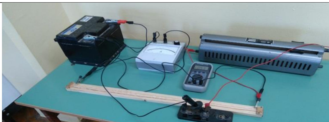
Slika S3.1. prikazuje električni strujni krug koji je spojen da bi odredili otpor vodiča ako je izvor stalnog električnog napona
