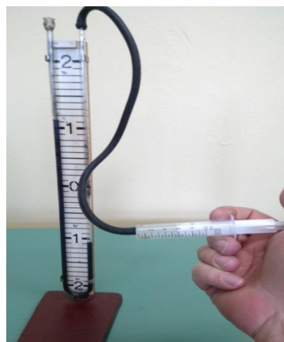
Slika S6.2. Uređaj na provjeru izotermne promjene stanja plina
