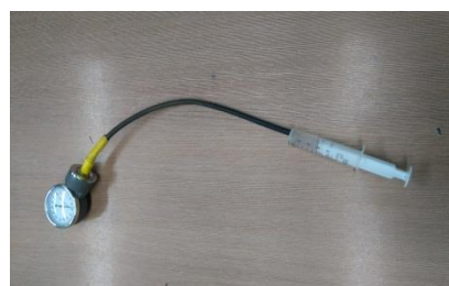
Slika S6.3. Uređaj za provjeru izotermne promjene stanja plina
