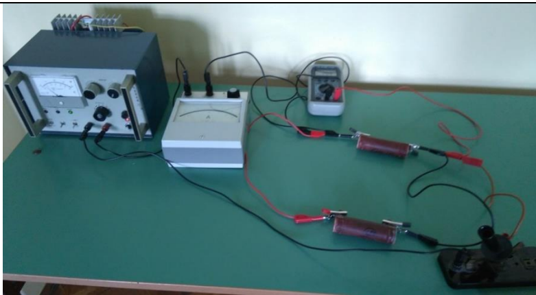
Slika E7.2. Paralelni spoj dvaju otpornika
