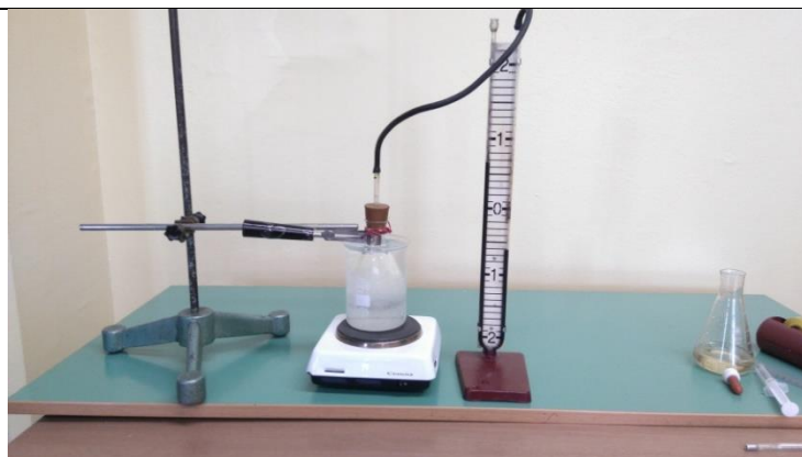
Slika S6.1. Uređaj za provjeru izohorne promjene stanja plina
