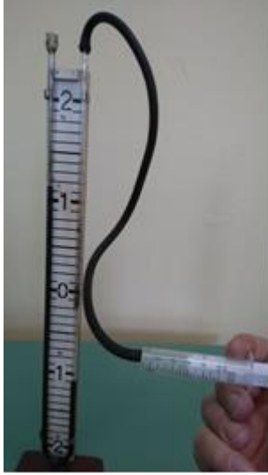
Slika S6. 2. Uređaj za mjerenje tlaka pri stalnoj temperaturi
