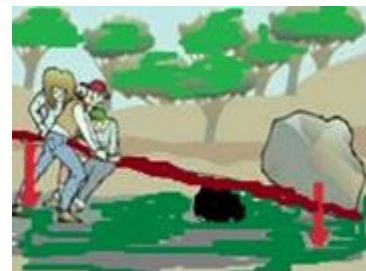
Slika M4.5. Podizanje kamena pomoću motke Izvor: Internet, kolovoz 2016.
