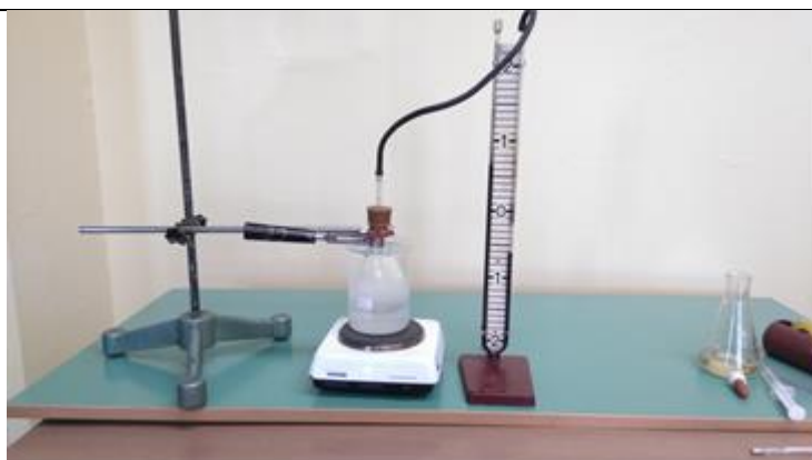
Slika S6.3. Uređaj za mjerenje tlaka pri konstantnom volumenu
