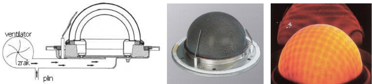
Slika 21. Zračni plamenik s kupolastom zračećom plohom
