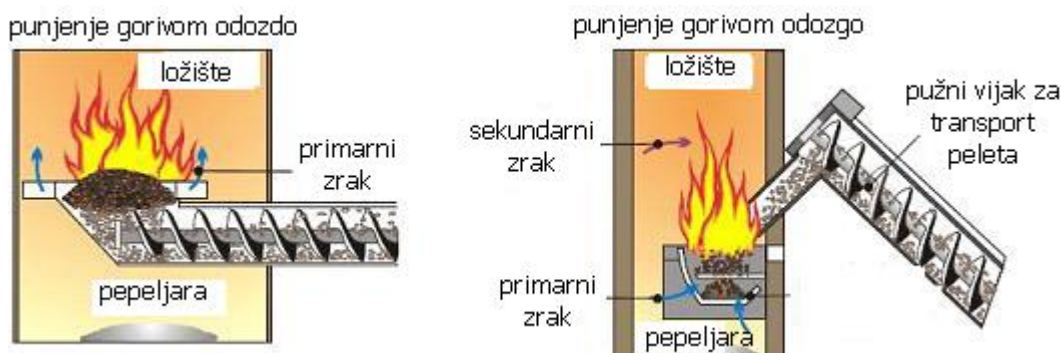
Slika 7. Načini punjenja ložišta peletima
