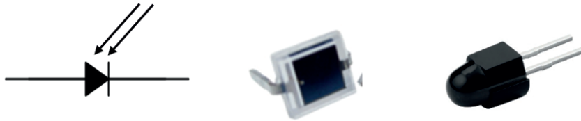
Slika 1.23: Simbol i primjer izvedbe fotodiode [Izvor: autorski rad]
