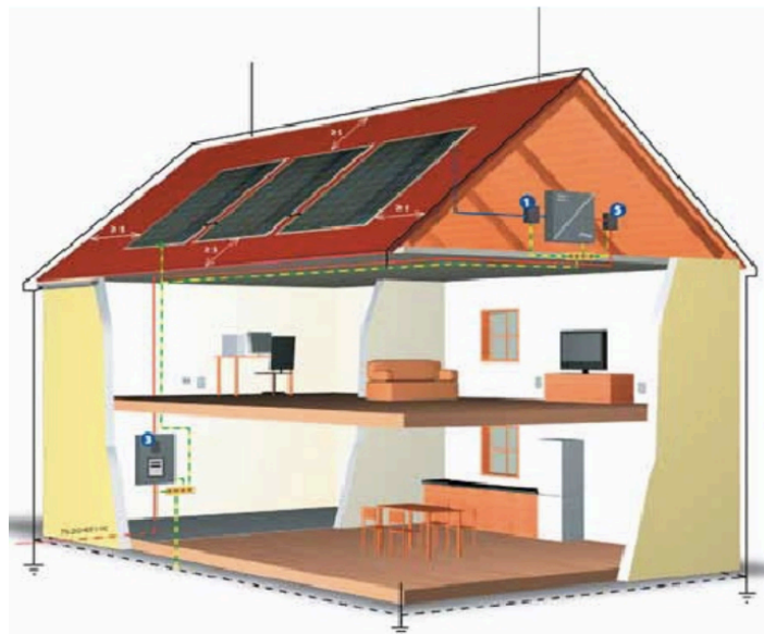
Slika 41. Fotonaponski sustav i gromobranska instalacija građevine [4]
