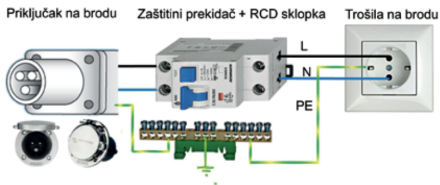
Slika 38. Priključak brodskih trošila na napajanje s obale [11]
