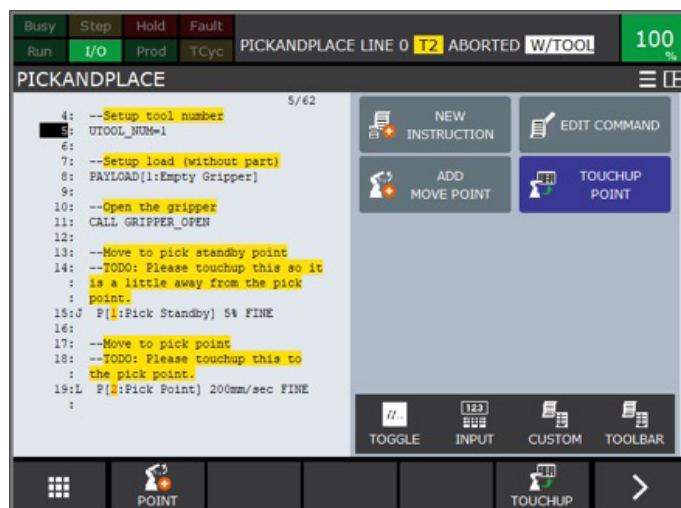
Slika 63. Prikaz inicijaliziranog predloška Podigni i spusti s dodanim određenim uobičajenim komandama robota za aplikaciju
