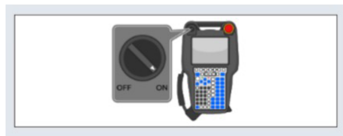
Slika 31. Prikaz preklopke za uključivanje ručne upravljačke jedinice
