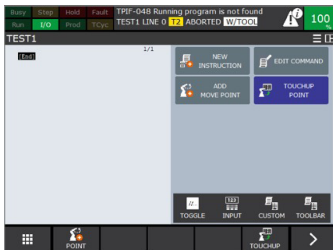
Slika 60. Inicijalizacija novog programa - na slici je prikazano da novi program nema niti jednu komandu osim END (što označava kraj programa)
