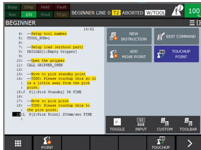
Slika 56. Primjer TP programa koji možemo otvoriti na zaslonu ručne upravljačke jedinice
