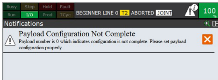
Slika 8. Detaljan opis greške (Nismo postavili parametar koji robotu govori s kojim opterećenjem radi u proizvodnom procesu - vrijednost u kg)
