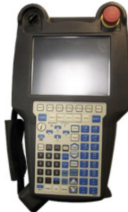
Slika 5. Ručna upravljačka jedinica FANUC robota
