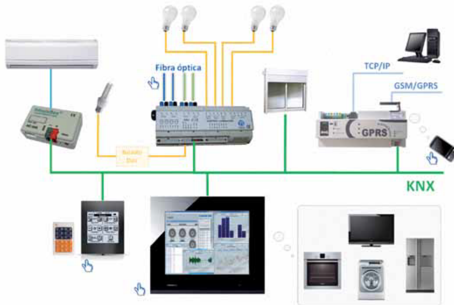
Slika 2.3: KNX sustav kuće ili stana za smanjenje potrošnje energije (izvor: knx.org, KNX Solutions)
