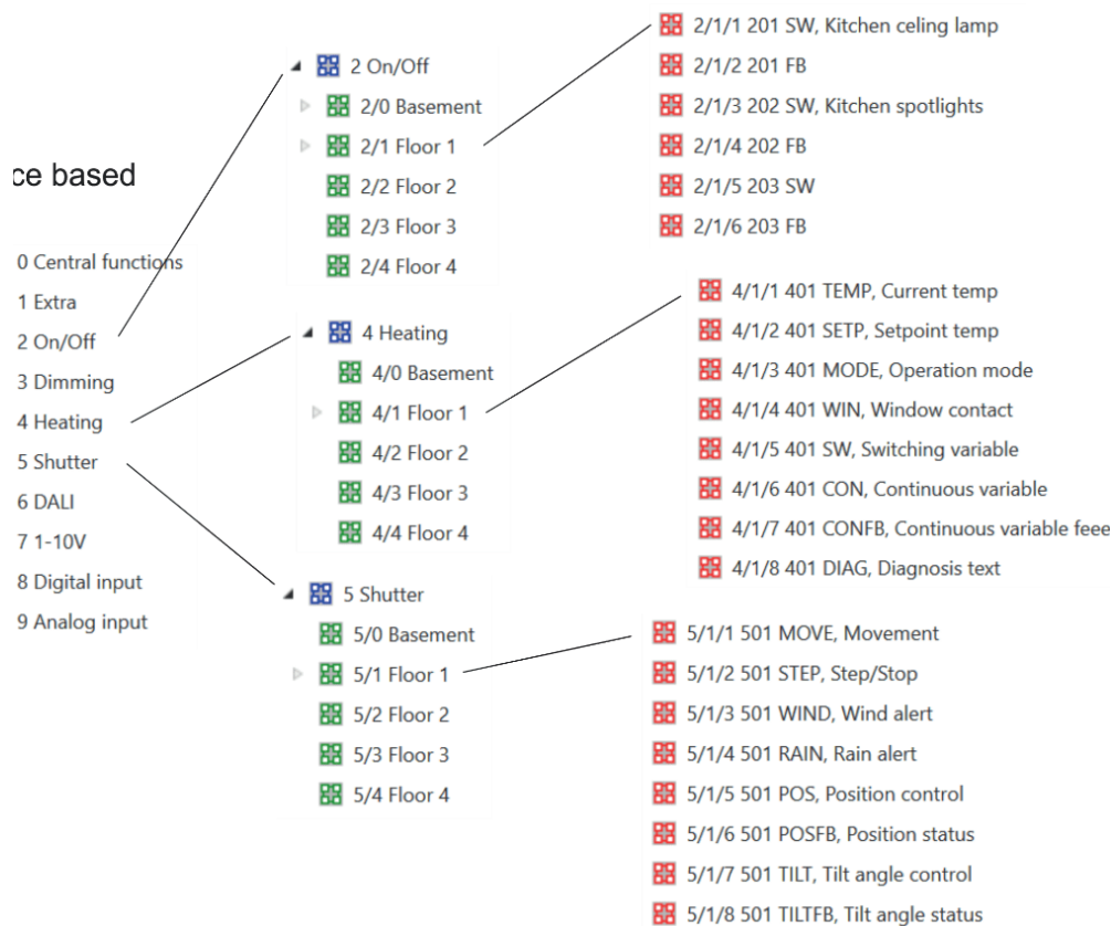
Slika 5.11: Struktura grupne adrese na temelju komponente (izvor: https://www.bemi.fi/knx-group-address-best-practices-and-guidelines/ )
