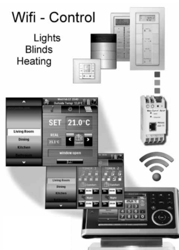
Slika 2.9: WLAN upravljanje (izvor: knx.org, KNX Solutions)
