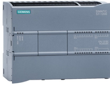
Slika 1.2. Kompaktni PLC tvrtke SIEMENS
