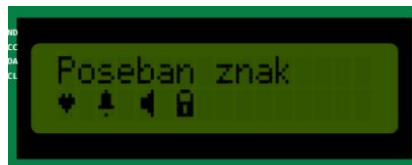
Slika 3.15: Ispis posebnih znakova na LCD zaslon (izvor: „Autorski rad“)
