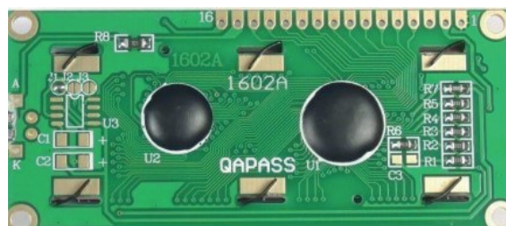
Slika 3.9: Prikaz LCD 16 x 2 zaslona (izvor: „Autorski rad“)
