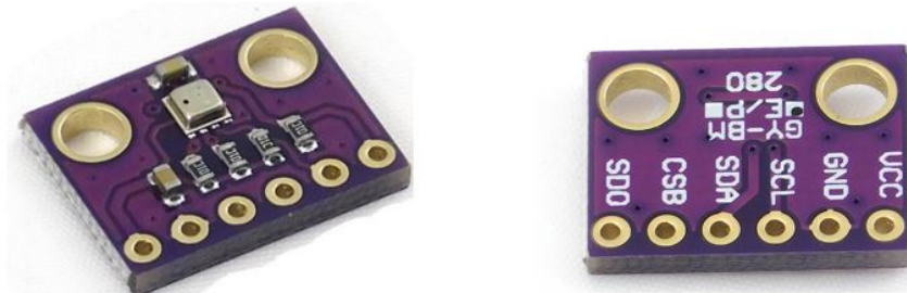
Slika 2.22: Senzor BME280 (izvor: „Autorski rad“)
