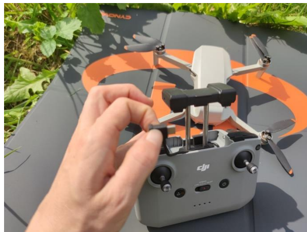
Slika 3-5. Kabel za povezivanje mobilnog telefona i daljinskog upravljača u ležištu je s prednje strane daljinskog upravljača.
