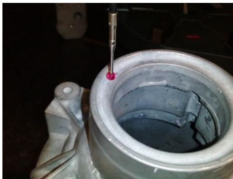
Slika 33. Postupak uzimanja mjerne točke na površini mjernog uzorka
