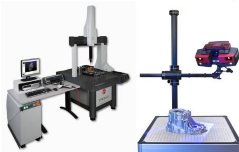
Slika 4. Primjer mjernih uređaja temeljenih na aktivnoj mjernoj metodi: a) TMU Erowa, b) 3D digitalizator ATOS
