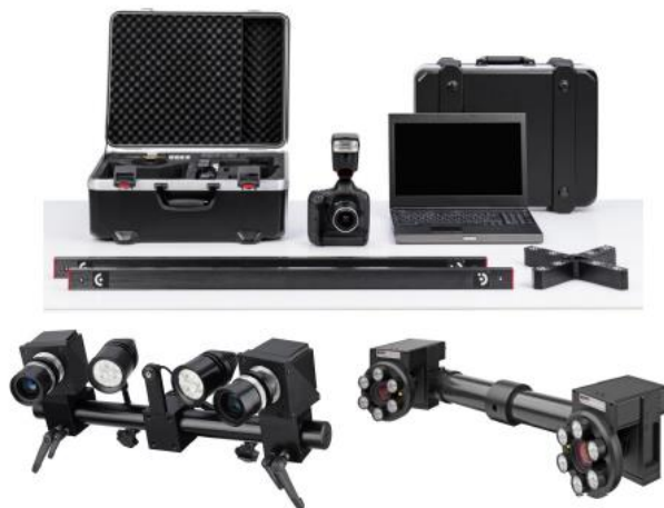
Slika 5. Primjeri pasivnih optičkih mjernih sustava (TRITOP, ARAMIS, PONTOS)
