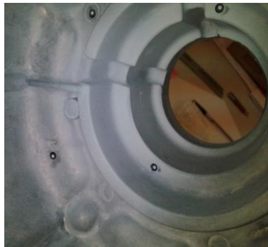
Slika 38. Mjerni uzorak s referentnim točkama
