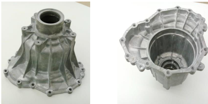
Slika 28. Predmet mjerenja - aluminijski odljevak poklopca diferencijala
