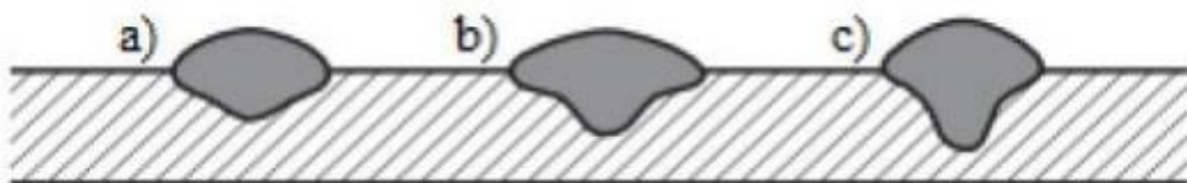
Slika 22. Povećanje dubine protaljivanja ovisno o struji a) mala struja b) srednja struja c) visoka struja
